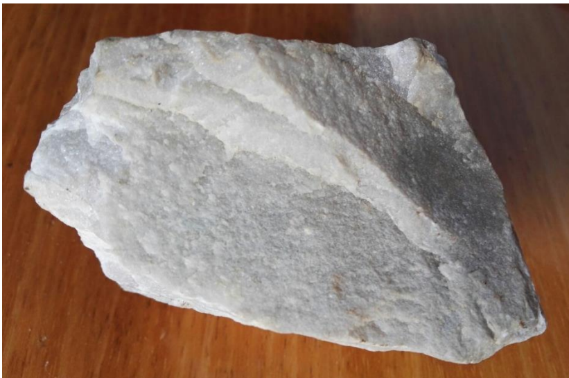
Figura 7.15 – Campione di marmo dolomitico prelevato in cava.
